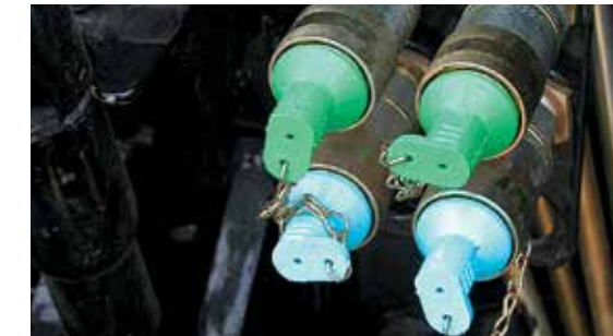
▲ El sistema auxiliar de control remoto ofrece 2 válvulas traseras.
